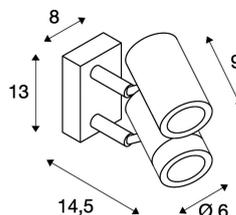
Die Wandleuchte ASTINA double spot besteht aus Edelstahl 316 und Glas, welches das Leuchtmittel abdeckt. Die funktionalen Leuchtenköpfe sind dreh- und schwenkbar. Bestückt ist die Leuchte mit zwei 3W Premium LED's. Durch die Schutzart IP44 ist sie für den Außenbereich geeignet. Der elektrische Anschluss der in mehreren Varianten verfügbaren Leuchte erfolgt an 230V Netzspannung. Die ASTINA Serie beinhaltet des Weiteren eine LED Variante in Edelstahl 304.
