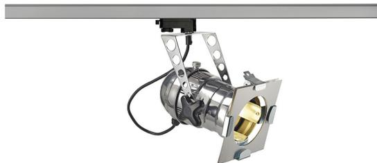
Dreh- und schwenkbarer PAR-Strahler SFL PAR36. Innerhalb des Aluminiumkörpers des PAR Strahlers befindet sich der GU10 Sockel. Somit ist der Strahler für den Einsatz von Halogen-, LED- und Energiesparleuchtmittel mit einem Durchmesser von 11cm geeignet. Der elektrische Anschluss erfolgt mittels des Adapters für das 3Phasen Hochvolt-Schienen-System.
