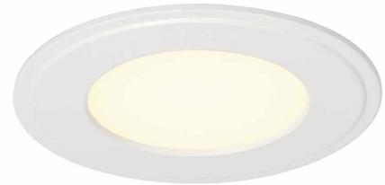
Die SENSER 12 Einbauleuchte aus Aluminium ist erhältlich in den Farben weiß und silbergrau sowie mit runder- und eckiger Blende. Der starre Premium LED-Einsatz ermöglicht durch den Abstrahlwinkel von 120° eine flächige, homogene Grundbeleuchtung. Zum Betrieb der Einbauleuchte wird ein passender Konstantstromtreiber mit 350mA benötigt.
