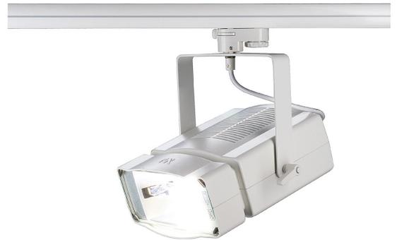
Dreh- und schwenkbarer Hochvoltstrahler SDL 70 mit passendem Adapter für das 3 Phasen Hochvolt Schienen-System. Um diesen Profi-Strahler mit verbautem Rx7s Sockel an jeden Einsatzort anzupassen, sind separat Blendkappen zur perfekten Ausrichtung verfügbar. Das zum Betrieb der Entladungslampe notwendige Vorschaltgerät ist im hinteren Teil der Leuchte verbaut.
