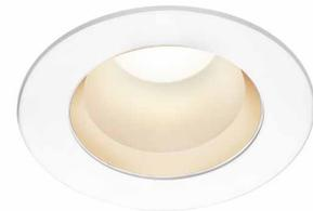
LED Deckeneinbauleuchten der RILO Serien überzeugen durch ihre innovative Technik. Die Lichtfarbe lässt sich über einen Schalter bei der Installation einstellen, der UGR Wert ist kleiner 19 und der Cri größer 90! Der Anschluss der in der Gehäusefarbe weiß verfügbaren Leuchte erfolgt direkt an 230V Netzspannung.
