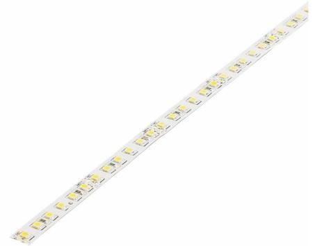
Flexibler LED Strip in 3 m Länge zum Anschluss an 24V Gleichspannungsnetzteile. Zur einfachen Montage ist die Rückseite mit Klebeband ausgestattet. Zu den in mehreren Lichtfarben verfügbaren Strips. Um bei größeren Längen gleichbleibende Lichtleistung zu erhalten, sollten die Strips beidseitig eingespeist werden. Ab einer Länge von 3 m muss neu eingespeist werden.
