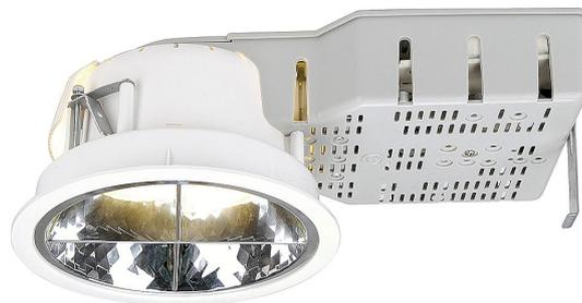
Das Raster Downlight PLADO 18W ist erhältlich in weisser Gehäusefarbe. Konzipiert für die Aufnahme eines Energiesparleuchtmittels des Typs TC-DE mit 18W Leistung, sorgt das bereits eingebaute, verlustarme Vorschaltgerät für den direkten Anschluss an 230V Netzspannung.
