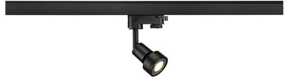
Dreh- und schwenkbares Hochvoltstrahler-Set PURI SPOT mit passendem Adapter für das 3 Phasen Hochvolt Schienen-System. Die aus Aluminium gefertigte Leuchte ist durch den verbauten GU10 Sockel für Halogen- sowie LED-Leuchtmittel geeignet. Ein Philips MASTER LED GU10 6W Leuchtmittel sowie ein leuchtenfarbener Dekoring befinden sich im Lieferumfang.
