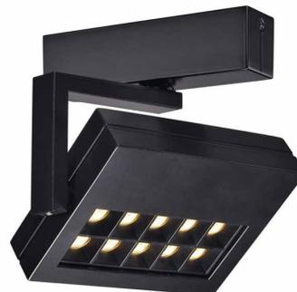
Moderner Hochvolt LED-Strahler PROFUNO mit passender Rosette für Wand- und Deckenmontage. Innerhalb des Rasters befinden sich 10 dimmbare Premium LEDs. Die dreh- und schwenkbare Leuchte ist in verschiedenen Farben erhältlich. Durch die werkseitig verbauten LED Treiber sind alle Leuchten der Serie für den direkten Anschluss an 230V Netzspannung geeignet.
