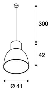
Der PARA MULTI DLMi Pendelleuchte ist mit ihren speziellen Lichtattributen ideal für den technisch, industriellen Bereich. Mit der Schutzklasse IP 20 ist sie vor äußeren Einflüssen geschützt. Die Pendelleuchte hat eine hohe Leistungsaufnahme von 18 Watt, was sie ideal zur Hallenbeleuchtung macht. Auch in Sachen Qualität kann die aus Stahl und Acryl gefertigte Leuchte voll und ganz überzeugen. Wann lassen Sie sich von den Vorteilen der SLV Indoor-Leuchten begeistern?
