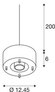
Mit ihren speziellen Lichtattributen ist die PARA DOME E27 für den technisch, industriellen Bereich konzipiert. Die Schutzklasse IP 20 schützt sie vor äußeren Einflüssen. Da sie eine hohe Leistungsaufnahme von 150 Watt bietet, eignet sich die Pendelleuchte perfekt zur Hallenbeleuchtung. Dazu überzeugt die aus Aluminium gefertigte Leuchte mit ihrer hochwertigen Qualität. Wann lassen Sie sich von den Vorteilen der SLV Indoor-Leuchten begeistern?
