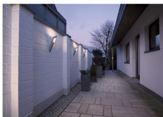
Die aus Aluminium gefertigte Fackel-Wandleuchte der OVIS Serie gibt Ihr Licht direkt sowie indirekt über zwei opale Leuchtflächen aus PC ab. Durch die Schutzart IP55 ist sie für den Außenbereich geeignet. Der elektrische Anschluss der in mehreren Farbversionen verfügbaren Leuchte erfolgt mittels der beiliegenden Anschlussbox an 230V Netzspannung. Die OVIS Serie beinhaltet des Weiteren Standleuchten sowie alternative Wandleuchten und ist somit universell einsetzbar.
