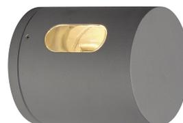
Einflammige aus Aluminium gefertigte Wandaufbauleuchte der OUT-BEAM Serie. Die beiden gegenüberliegenden, mit Glas abgedeckten Lichtauslässe geben jeweils einen engen Beam ab und erzeugen somit den besonderen up/down Effekt. Durch die Schutzart IP44 ist die Leuchte für den Außenbereich geeignet. Der elektrische Anschluss der in mehreren Farbversionen verfügbaren Leuchte erfolgt direkt an 230V Netzspannung. Die OUT-BEAM Serie beinhaltet des Weiteren runde Wandleuchten.
