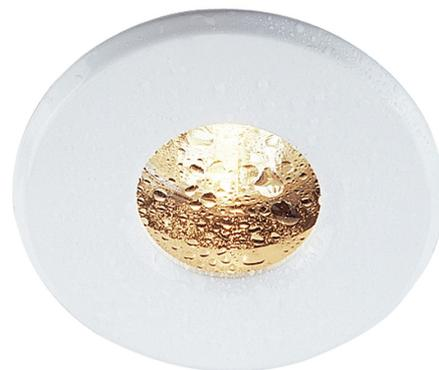
Der OUT 65 Niedervolt Deckeneinbauring ist aus Aluminium gefertigt und mit einem Glas zum Schutz gegen Spritzwasser ausgestattet. Mit seiner Schutzart IP65 ist er im Außenbereich oder in Feuchträumen einsetzbar. Zum Betrieb des Downlights wird ein passender Transformator für Niedervolt Halogen Leuchtmittel benötigt.
