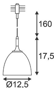
Niedervoltpendelleuchte ORION PENDEL mit passendem Adapter für das LINUX LIGHT Schienen-System. Die aus Aluminium und einem satiniertem Glas Leuchtschirm gefertigte Leuchte ist durch den verbauten GY6,35 Sockel für Halogenleuchtmittel geeignet. Die Pendellänge der in mehreren Farbversionen verfügbaren Leuchte beträgt 1,5m.
