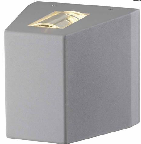
Einflammige, aus Aluminium gefertigte LED Wandleuchte der OUT-BEAM Serie. Die beiden gegenüberliegenden, mit Glas abgedeckten Lichtauslässe geben jeweils einen engen Beam in einem warmweißen Farbton ab und erzeugen somit den besonderen up/down Effekt. Durch die Schutzart IP44 ist die Leuchte für den Außenbereich geeignet. Der elektrische Anschluss der Leuchte erfolgt direkt an 230V Netzspannung.
