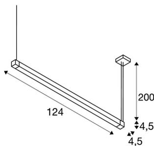
Die OPEN GRILL Pendelleuchte ist eine professionelle Leuchte für die Aufbaumontage. Innerhalb des schwenkbaren Rahmens befinden sich warmweiße LED und sorgen für wahlweise direkte oder indirekte Beleuchtung. Die OPEN GRILL Pendelleuchte ist für den direkten Anschluss an 230V Netzspannung geeignet.
