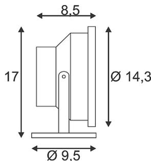
Mobiler, aus witterungsbeständigem Edelstahl gefertigter Strahler der NAUTILUS Serie. Der elektrische Anschluss erfolgt mittels Zuleitung inkl. Netzstecker direkt an 230V Netzspannung. Durch die Schutzart IP67 ist der Strahler für den Außenbereich geeignet. Der mittels Bügel an der Bodenplatte montierte Leuchtenkopf ist zur optimalen Ausleuchtung schwenkbar. Als optionales Montagezubehör ist ein Erdspieß verfügbar.
