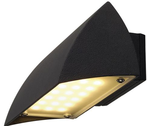
LED Wandanbauleuchte NOVA WALL bestehend aus lackiertem Aluminium und satiniertem Glas, welches die LED abdeckt. Durch Schutzart IP44 für den Außenbereich geeignet. Der elektrische Anschluss Leuchte erfolgt durch den verbauten LED Treiber direkt an 230V Netzspannung. Die Lampen können in der Leuchte nicht ausgetauscht werden.
