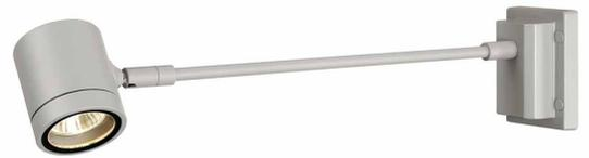
Die starre Displayleuchte der MYRA Serie besteht aus lackiertem Aluminium und Glas welches das Leuchtmittel abdeckt. Der am gradem Ausleger montierte Leuchtenkopf ist dreh-, und schwenkbar. Durch die Schutzart IP55 ist sie für den Außenbereich geeignet. Der elektrische Anschluss der in mehreren Farbversionen verfügbaren Leuchte erfolgt an 230V Netzspannung. Die MYRA Serie beinhaltet des Weiteren Stand- sowie Wandleuchten und ist somit universell einsetzbar. +
