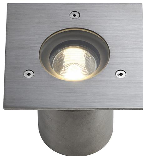
Die begehbare Hochvoltbodeneinbauleuchte mit quadratischer Edelstahlblende und teilsatinierter Glasabdeckung ist mit einer GU10 Fassung ausgestattet und somit kompatibel mit Halogen-, bzw. LED Lampen. Durch die Schutzart IP67 ist die Leuchte für den Außenbereich geeignet. Der elektrische Anschluss erfolgt direkt an 230V Netzspannung. Zur einfachen Montage befindet sich ein Einbautopf im Lieferumfang. Alternativ zum Boden, kann die Leuchte auch in die Wand eingelassen werden.
