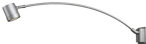
Die Wandanbaudisplayleuchte der MYRA Serie besteht aus lackiertem Aluminium und Glas welches das Leuchtmittel abdeckt. Der am gebogenem Ausleger montierte Leuchtenkopf ist dreh-, und schwenkbar. Durch die Schutzart IP55 ist sie für den Außenbereich geeignet. Der elektrische Anschluss der in mehreren Farbversionen verfügbaren Leuchte erfolgt an 230V Netzspannung. Die MYRA Serie beinhaltet des Weiteren Steh- sowie Wandleuchten und ist somit universell einsetzbar.
