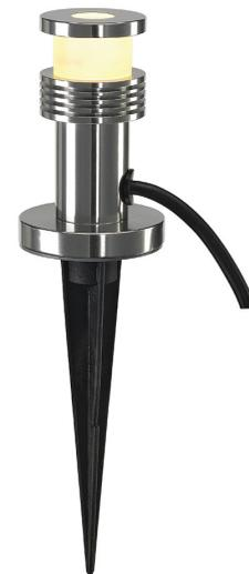
Bei der aus Aluminium gefertigten Stehleuchte ist die leistungsstarke, warmweiße PowerLED von satiniertem Acryl abgedeckt. Der elektrische Anschluss erfolgt mittels Zuleitung inkl. Netzstecker direkt an 230V Netzspannung. Zur Erleichterung der Montage befindet sich ein Erdspeiß im Lieferumfang der Leuchte. Durch die Schutzart IP44 ist die in zwei Höhen verfügbare Leuchte für den Außenbereich geeignet.
