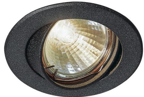
Das MR11 SP Niedervolt Downlight aus Aluminium ist erhältlich in den Farben weiß, silbergrau, schwarz, chrom und chrom matt. Der Einbauring ist schwenkbar und wurde für den Einsatz eines Niedervolt Halogenleuchtmittels für den Fassungsyp MR16 konzipiert. Zum Betrieb des Downlights wird ein passender Transformator mit 12V Wechselspannung benötigt.
