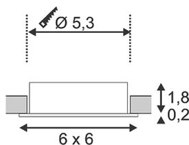
Die LELEX 1 Einbauleuchte besteht durch ihre geringe Einbautiefe und ist daher optimal für den Einsatz in Schränken und anderen Möbelstücken. Eine langlebige LED Diode mit einer Leistung von 1W sorgt für die nötige Beleuchtungsstärke und ist wahlweise verfügbar in den Lichtfarben neutral- und warmweiß. Zum Betrieb der Einbauleuchte wird ein passender Konstantstromtreiber mit 350mA benötigt. Diese Leuchte enthält eingebaute LED-Lampen.
