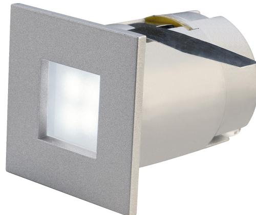
Der starre LED Einbauspot MINI FRAME LED wurde aus einer Kunststoff-Glas Kombination hergestellt und ist die LED-Lichtlösung für Anwendungen, bei denen punktuelle Akzentbeleuchtung und geringe Einbautiefe benötigt werden. Die wahlweise blaue, rein- oder warmweisse 1W LED sorgt für die benötigte Beleuchtungsstärke. Zum Betrieb des Spots wird ein passender, konventioneller Transformator mit 12V Wechselspannung benötigt.
