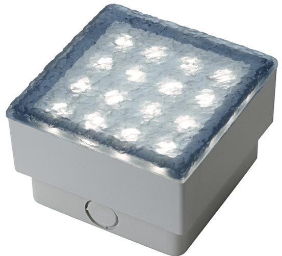
Begehbare LED Bodeneinbauleuchte, die durch die quadratische Form sowie der Oberflächenstruktur für den Einsatz in Pflasterflächen genutzt werden kann. Der elektrische Anschluss der mit warm- oder kaltweißen LEDs bestückten Leuchte erfolgt durch den verbauten Treiber direkt an 230V Netzspannung. Zur Montageerleichterung liegen der Leuchte Einbautopf, Schrumpfschlauch sowie Quetschverbinder bei. Durch die Schutzart IP67 ist die Leuchte für den Außenbereich geeignet.
