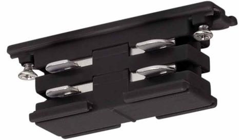
Starrer Verbinder für das Hochvolt 3Phasen-Aufbauschiene-System. Bei abgehängter Montage aus statischen Gründen nur in Verbindung mit Stoßstellenverbinder einsetzbar.
