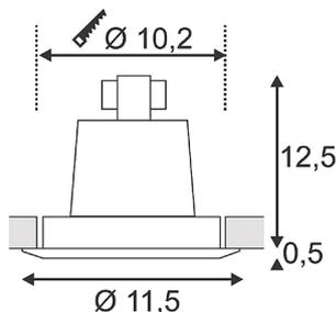
Die LUZO INTEGRATED LED Einbauleuchte ist eine Kombination aus hochwertigem Leuchtengehäuse und effizientester LED-Technologie aus dem Hause PHILIPS. Neben einer geringen Gesamtleistung trotz hoher Lichtausbeute und einer brillanten LED-Lichtfarbe von wahlweise 2700K, 3000K und 4000K, lässt sich zudem das LED-Modul der LUZO INTEGRATED LED aus tauschen. Diese Leuchte enthält eingebaute LED-Lampen.
