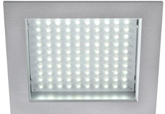
Das eckige Hochvolt LEDPANEL 100 ist mit einhundert, wahlweise rein- oder warmweissen, Leuchtdioden bestückt, die in einem silbergrau lackierten Leuchtengehäuse verbaut sind. Dank des bereits integrierten LED Konverters, ist LEDPANEL 100 fertig für den direkten Anschluss an 230V Netzspannung.
