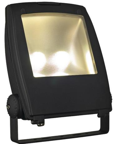
Leistungsstarker LED OUTDOOR Strahler zur Beleuchtung von Flächen und Plätzen. Durch den schwenkbaren Montagebügel sowie die Schutzart IP65 ist der Strahler für die Außenmontage an Wand und Boden geeignet. Der elektrische Anschluss des in warm- und neutralweiss verfügbaren Strahlers erfolgt direkt an 230V Netzspannung. Die Lampen können in der Leuchte nicht ausgetauscht werden.
