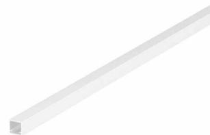
Das milchige KENAI Profil in 2 m Länge mit 12 mm Breite und 12 mm Höhe ist für flache, schmale LED-Strips vorgesehen. Maximale Strip-Leistung 10W pro Meter.
