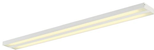
Die KUNO Deckenleuchte mit weiss lackiertem Leuchtgehäuse überzeugt durch klare Formgebung und effektive Ausleuchtungseigenschaften. Zwei unterseitig angebrachte Diffusoren aus Acrylglas sorgen für Blendfreiheit der zum Einsatz gebrachten T5 Leuchtstoffröhren mit je 35W Leistung. Dank der bereits integrierten Vorschaltgeräte ist die KUNO Deckenleuchte fertig für den direkten Anschluss an 230V Netzspannung.
