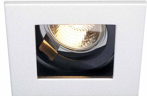
Die einflammige Hochvolt Einbauleuchte INDI REC 1S ist kardanis schwenkbar und wurde für den Einsatz von Hochvolt Halogenleuchtmitteln konzipiert. Das äußerlich weiß matte Stahlgehäuse ist im Inneren schwarz gehalten. Zum Betrieb der Einbauleuchte wird ein passender Transformator mit 12V Wechselspannung benötigt.
