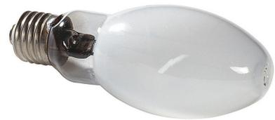
Halogen-Metaldampflampen mit Quarzbrennern und guter Farbwiedergabe speziell für offene Leuchten. Stabile Farbtemperatur über die gesamte Lebensdauer. Bis zu 70% Energieersparnis gegenüber gleichwertigen Anlagen mit Quecksilberdampflampen.
