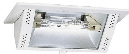
Das HQI-TS DL 70 Deckeneinbaudownlight für gewerbliche Anwendungen und solche mit hohen Anforderungen an klare Lichteigenschaften. Verfügbar in den Gehäusefarben weiss und silbergrau ist es für die Aufnahme einer 70W Halogenmetall dampflampe für Rx7s Fassung vorbereitet. Zum Betrieb des Downlights wird ein passendes, elektronisches Vorschaltgerät, sowie eine entsprechende Hochvolt Anschlussleitung benötigt.
