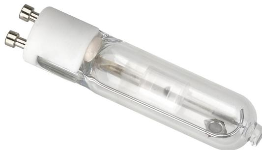
Miniaturisierte, einseitig-gesockelte Metallhalogendampflampe. GU6.5 Twist-and-Lock-Lampensockel gemäß IEC-Norm. Der gewichtete Verbrauch liegt bei 22kWh/1000h.
