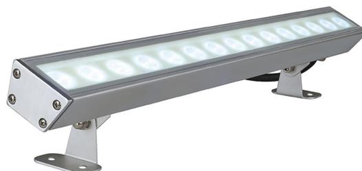
Mit 15 leistungsstarken PowerLEDs bestücktes Aluminiumprofil. Durch die bereits montierten Montagehalter kann die Montage direkt an Wand, Decke und Boden erfolgen. Durch die Schutzart IP65 ist das schwenkbare Profil auch für den Außenbereich geeignet. Der elektrische Anschluss des in neutral- und warmweiss verfügbaren Profils erfolgt mittels verbauter Zuleitung an einen 350mA Konstantstromtreiber.
