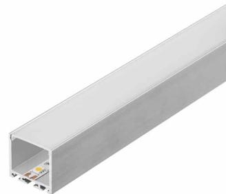
GLENOS Profi-Profil 3030 in 200 cm Länge exklusive Abdeckung zur Montage von LED Strips bis 30 mm Breite. Das in schwarz matt, weiß matt und silber erhältliche Profil kann als Einbau-, Aufbau oder samt optionalem Abhängeset 213488 auch als Pendelvariante eingesetzt werden.
