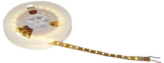
Flexibler, 24V DC LED Strip dessen Rückseite zur einfachen Montage mit Klebeband ausgestattet ist. Der elektrische Anschluss des in mehreren Längen und Lichtfarben verfügbaren Strips erfolgt an ein kompatibles 24V Gleichspannungsnetzteil. Als weiteres Zubehör sind Einspeisekabel, Direktverbinder sowie 90° Lötecken verfügbar.
