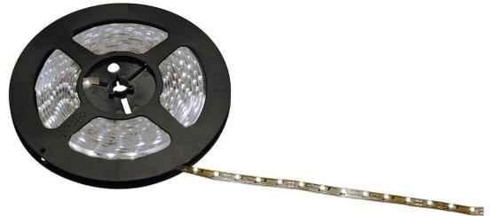
Flexibler, 12V DC LED Strip dessen Rückseite zur einfachen Montage mit Klebeband ausgestattet ist. Der elektrische Anschluss des in mehreren Längen und Lichtfarben verfügbaren Strips erfolgt an ein kompatibles 12V Gleichspannungsnetzteil. Als weiteres Zubehör sind Einspeisekabel, Direktverbinder sowie 90° Lötecken verfügbar.
