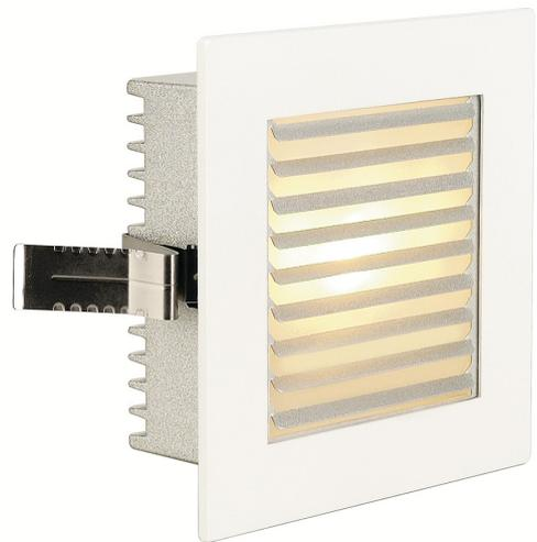
Mit unserer FLAT FRAME Serie bieten wir Ihnen die Platz sparende Lichtlösung für den Wand- und Deckeneinbau. Bereits vorbereitet für die Aufnahme von G4 Stiftsockelleuchtmitteln benötigen Sie zum Betrieb der Leuchte nur noch einen entsprechenden Transformator mit 12V Wechselspannung. Ein passender Unterputzrahmen sowie eine Einbaudose sind optional erhältlich.
