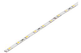
Flexibler, besonders schmaler LED Strip mit nur 4,8 mm Breite zum Anschluss an 24V Gleichspannungsnetzteile. Zur einfachen Montage ist die Rückseite mit Klebeband ausgestattet. Zu den in mehreren Lichtfarben und Längen verfügbaren Strips sind als Zubehör:
