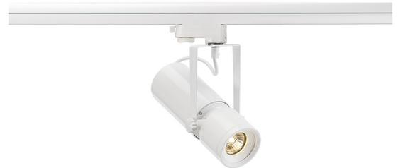
Dreh- und schwenkbarer Niedervoltstrahler EURO SPOT MR16 mit passendem Adapter für das 3 Phasen Hochvolt Schienen-System. Durch den im zylindrischen Aluminium Leuchtenkopf verbauten GU5,3 Sockel ist die Leuchte für Halogen- und LED-Leuchtmittel mit einem Durchmesser von bis 5cm geeignet. Im hinteren Teil des Leuchtenkopfes befindet sich der moderne, elektronische Transformator.
