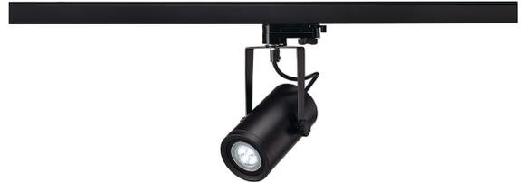
Dreh- und schwenkbarer Hochvolt LED-Strahler EURO SPOT INTEGRATED LED mit passendem Adapter für das 3 Phasen Hochvolt Schienen-System. Innerhalb des zylindrischen Leuchtenkopfes ist werkseitig das leistungsstarke Philips Fortimo Integrated Spot Modul verbaut. Der in mehreren Farben verfügbare Strahler ist in den Lichtfarbvarianten kalt-, neutral und warmweiss erhältlich. Des Weiteren stehen drei unterschiedlich Abstrahlwinkel zur Verfügung.
