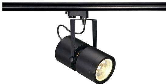
Dreh- und schwenkbarer Profi Hochvoltstrahler EURO SPOT G12 mit passendem Adapter für das 3 Phasen Hochvolt Schienen-System. Der für G12 Entladungslampen konzipierte Strahler ist durch das verbaute Vorschaltgerät für 70W Leuchtmittel geeignet. Des Weiteren ist er in mehreren Farben sowie Abstrahlwinkeln verfügbar. Das Vorschaltgerät ist im hinteren Teil des zylindrischen Leuchtenkopfes verbaut.
