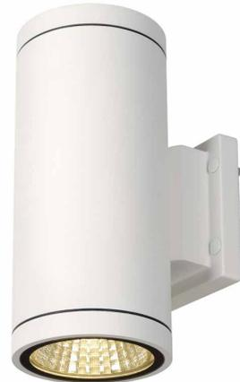
Die puristische up/down Wandleuchte ENOLA\_C besteht aus einer zylindrischen Aluminium Konstruktion und ist bestückt mit zwei warmweißen hochleistungs COB LED. Durch den eingebauten LED-Treiber erfolgt der elektrische Anschluss der in weiß und anthrazit erhältlichen Leuchte direkt an 230V Netzspannung. Die Lampen können in der Leuchte nicht ausgetauscht werden.
