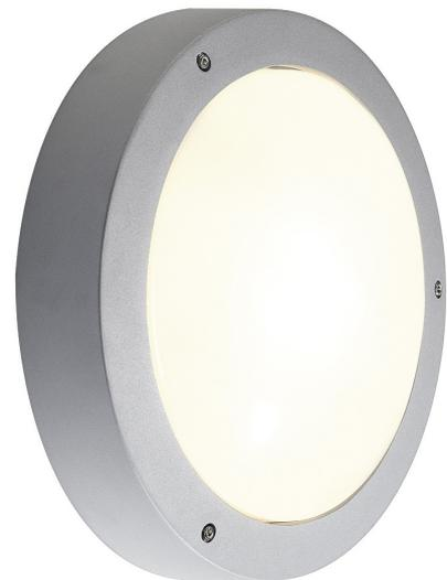
Runde Wand- und Deckenleuchte DRAGAN aus Aluminium die durch die Schutzart IP44 für den Außenbereich geeignet ist. Die opale Leuchtfläche aus PC wird durch das lackierte Gehäuse eingefasst. Der elektrische Anschluss der in mehreren Farbversionen verfügbaren Leuchte erfolgt durch das verbaute Vorschaltgerät direkt an 230V Netzspannung.
