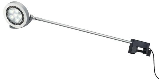
Kardanisch dreh- und schwenkbare Hochvolt Displayleuchte DomeLED DISPLAY. Die aus Aluminium gefertigte Leuchte verfügt im Leuchtenkopf über 6 hochleistungs PowerLEDs. Die Montage der in zwei Lichtfarben verfügbaren Leuchte erfolgt mittels im Lieferumfang befindlicher Displayklemme. Der elektrische Anschluss wird durch den verbauten Treiber sowie der Zuleitung inklusive Netzstecker direkt an 230V Netzspannung vorgenommen.
