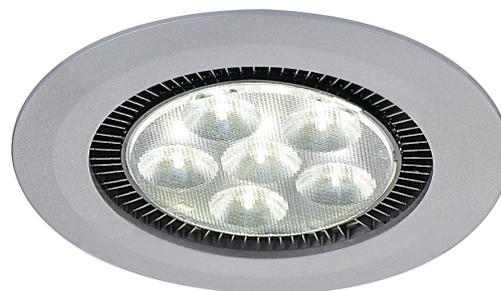
Das DOME LED Downlight vereint gleich sechs leistungsstarke und langlebige Dioden mit je 3W in einem formschönen und kompakten Leuchtengehäuse und ist erhältlich in den Lichtfarben rein- und warmweiss. Zum Betrieb des Downlights wird ein zusätzlicher Konstantstromtreiber mit 700mA benötigt.
